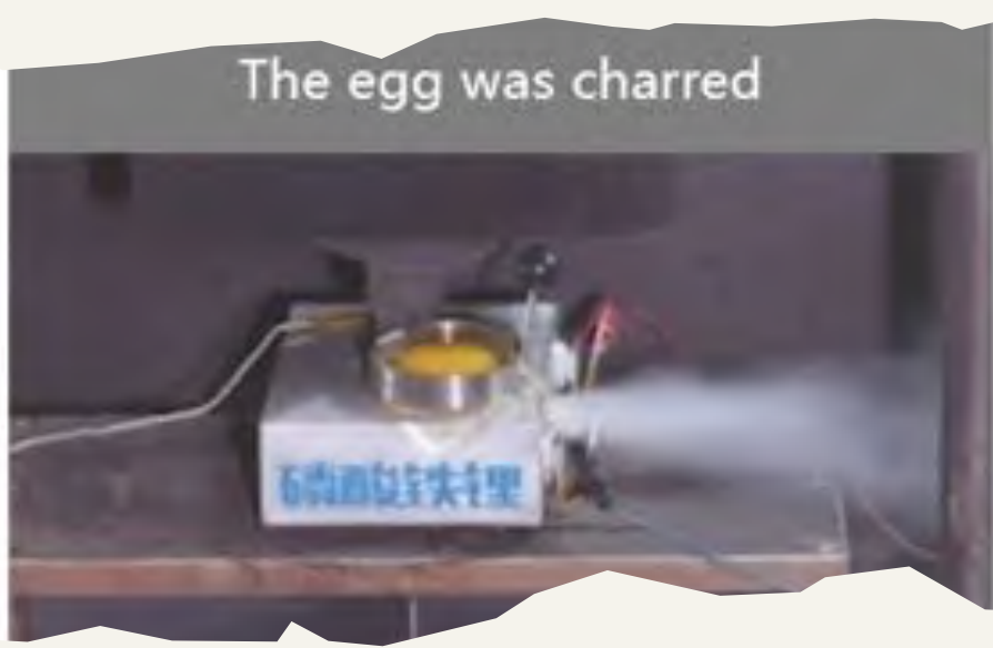
2 比亚迪欧洲官网展示了其刀片电池如何成功通过行业内最严苛的安全测试之一——“针刺测试”。
